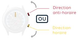
Positionnez l'aiguille des minutes sur l'index 30 Validation par appui simultané des deux boutons 1s Cette validation bascule vers le réglage des heures
