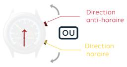
Positionnez l'aiguille des heures sur l'index 12 Pour sortir du mode calibration : Validation par appui simultané des deux boutons 1s
