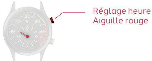
Lorsque l'aiguille des heures (rouge) tremble toutes les secondes, cela confirme que vous êtes entrés dans le mode de réglage avec succès.
